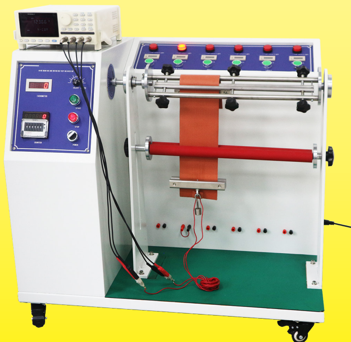
弯曲试验中的柔性硅胶加热器
